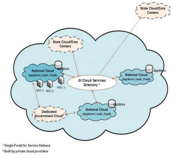
Figure 2: GI Cloud Meghraj Architecture<sup>45</sup>
